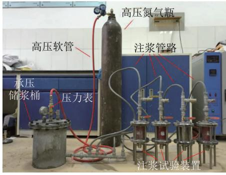
图1 渗透注浆试验装置现场照片<sup>[32]</sup>
