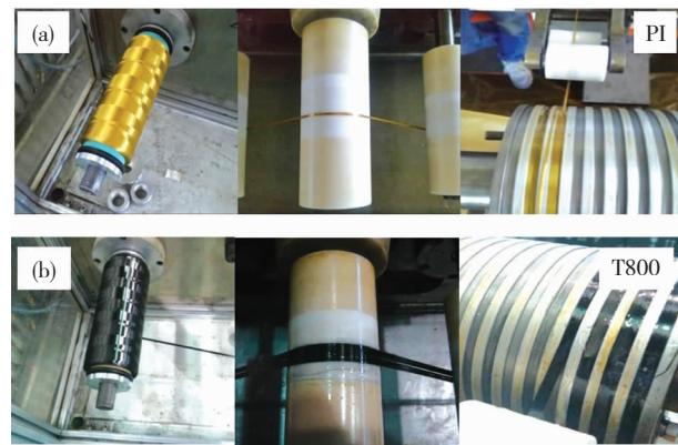
图3 复合材料NOL环缠绕成型工艺试验
