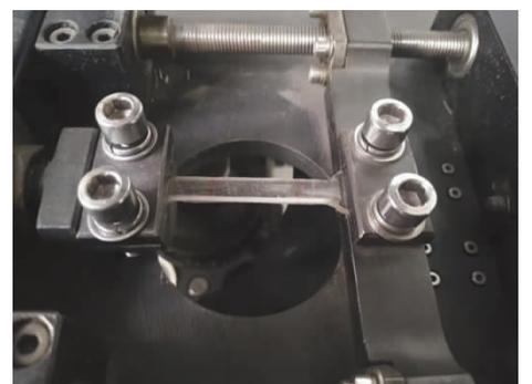
图 3 单丝断裂实验试样夹持装置
