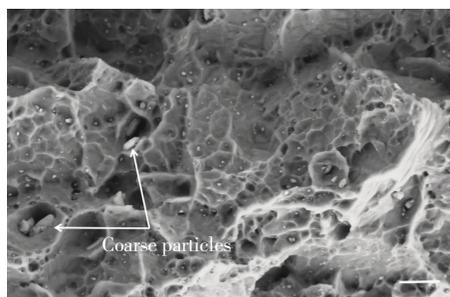
图 6 试样的拉伸断口形貌
