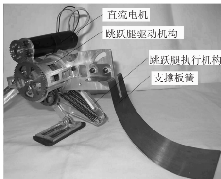
(b) 机器腿压缩状态右侧视图
