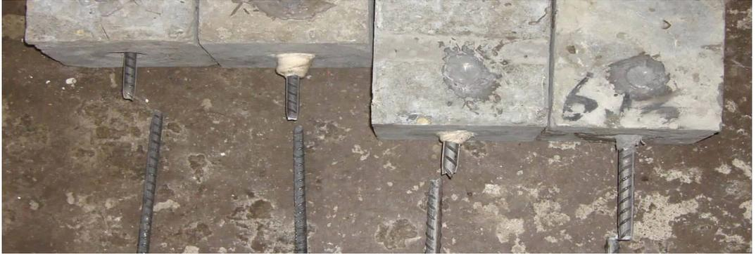
图 9 钢筋锚固试验试件破坏图
