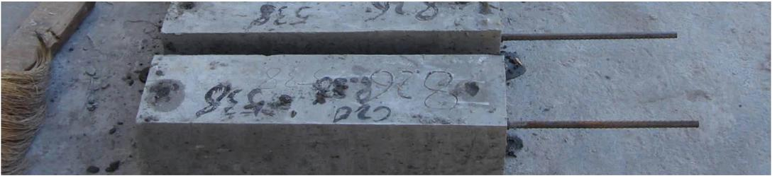
图 7 试件灌浆锚固
