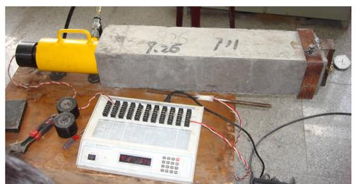
图 8 钢筋锚固性能拉拔试验装置图
