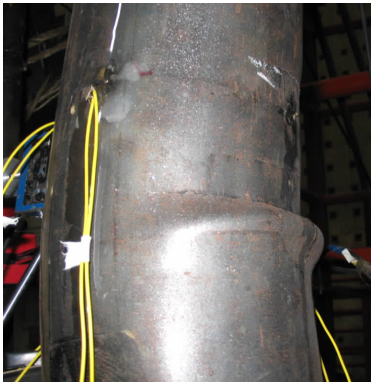
(c) 混凝土压溃
