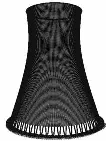
图 6 冷却塔结构有限元模型
