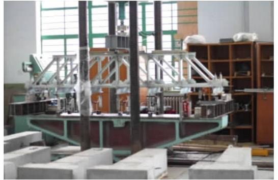
图1 钢桁架加载示意
