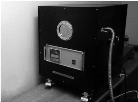
图 20 面式黑体硬件研制实物图
