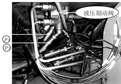
p_1 —后桥制动压力; p_2 —前桥制动压力
