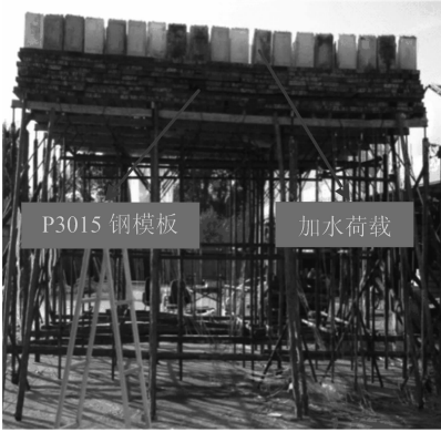
图 3 现场整体加载试验
