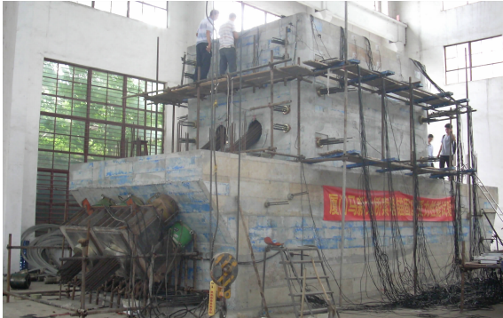
图 3 索塔锚固区试验方案
