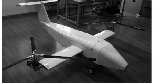
图 1 无人倾转旋翼飞行器实物图
