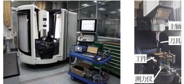
图 9 CFRP 开槽加工现场及工件装夹示意
