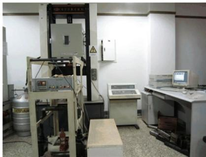
图 3 电子万能试验机及配套低温试验设备
