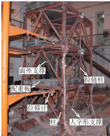
图 1 试验模型就位图
