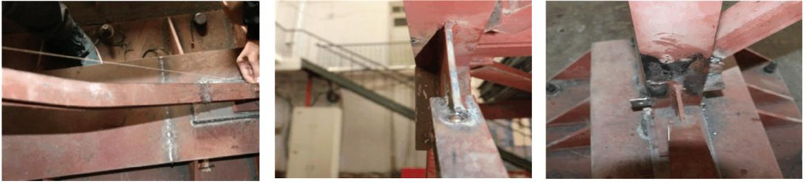
(a) 底层支撑发生平面外失稳
