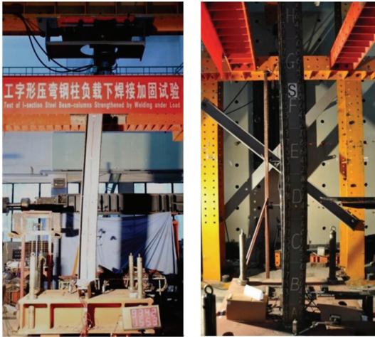
(a) 面内 (b) 面外 图 7 典型失稳破坏形态 (BCS2)
