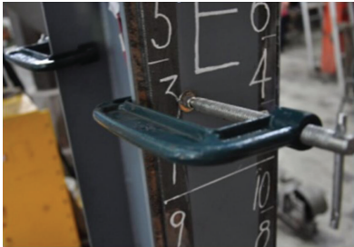
(a) G 型夹钳固定加固板
