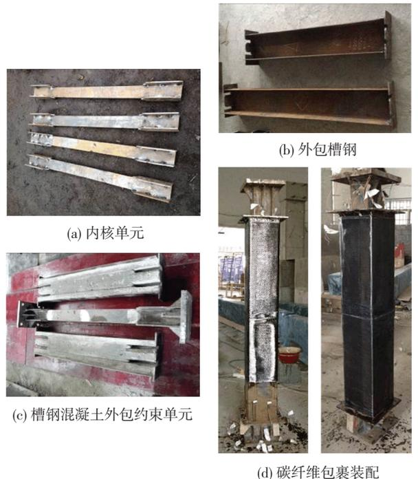
图 3 装配式防屈曲支撑制作过程
