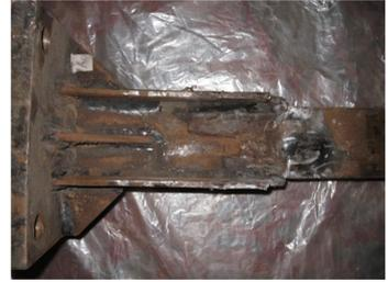
(a) 试件发生断裂
