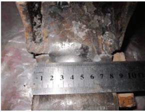
(a) 试件发生断裂
