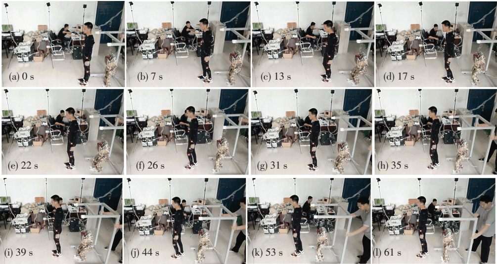
图 18 机器人跟随人步行实验视频截图(第 2 组:跟随身高 1.78 m 男性青年)(光滑瓷砖地面)
