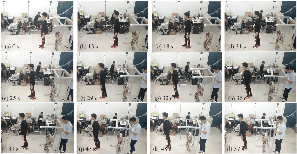
图 17 机器人跟随人步行实验视频截图(第 1 组:跟随身高 1.75 m 男性青年)(光滑瓷砖地面)
