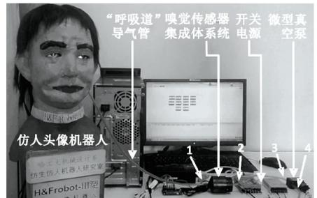
图 1 用于仿人头像机器人的人工肺-嗅觉系统实物图
