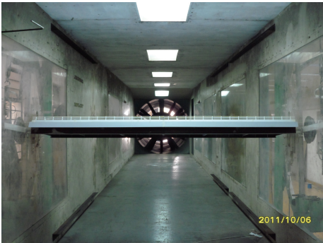
图 5 斜拉桥节段模型测振风洞试验
