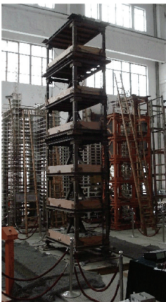
图 8 结构模型 Fig.8 Structure model
