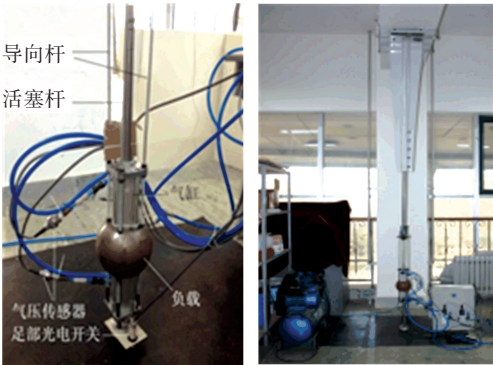
(a) 弹跳腿 (b) 实验台全景图 图 4 单足垂直跳跃机器人实验平台
