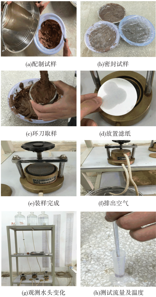
图 3 试样配制及试验步骤
