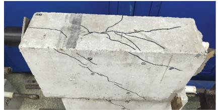
(b) 劈裂拔出破坏
