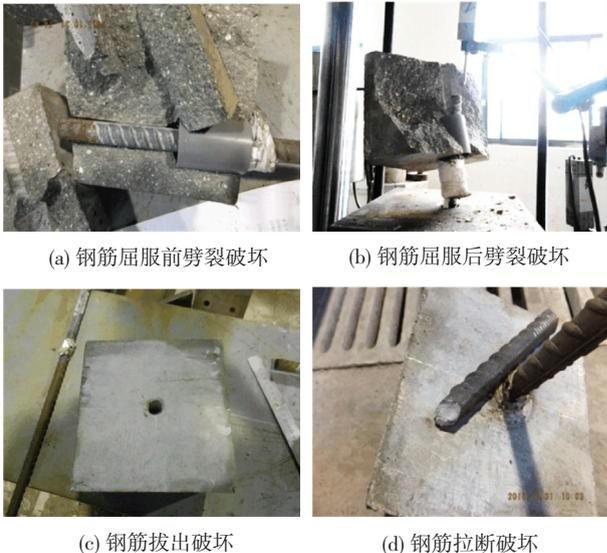
图 4 试件破坏形态
