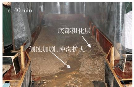
图 8 雨型三物源体破坏照片
