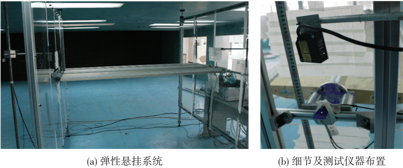
图 5 同步测力、测压和测振节段模型安装
