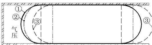
图 12 直径偏小的气囊在外气压下的变形过程
