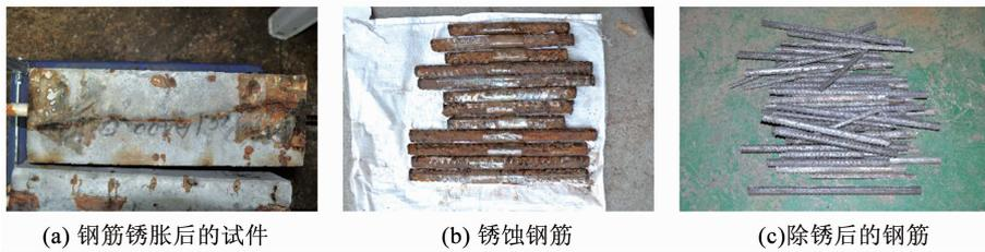
图 4 锈蚀照片
