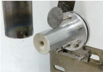
图5 微牛级会切型霍尔推力器实验样机
