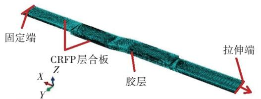
图 6 CFRP FJF 胶接连接接头三维有限元模型
