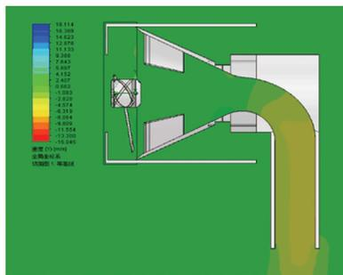
(b) 内部流道 Z 方向速度云图
