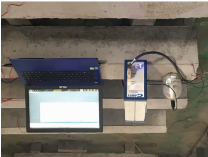
图 3 动电位极化曲线测试
