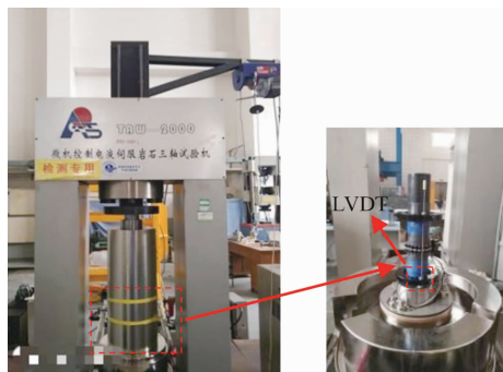
图 1 TAW2000 电液伺服岩石三轴试验机
