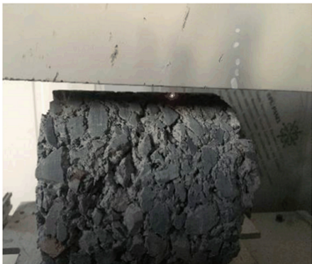
图 6 芯样侧壁构造深度激光扫描
