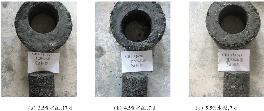
图 4 级配 3 不同标养龄期取芯芯样状态图
