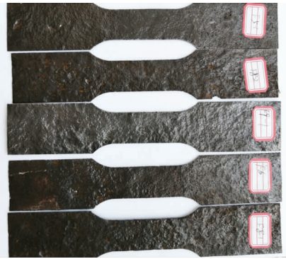
图 3 除锈后的试件表面 Fig. 3 Specimen surface after rust removal
