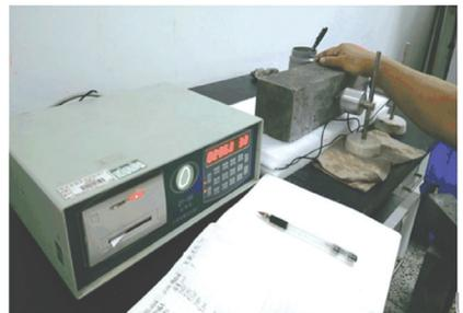
图 7 混凝土动弹模测定仪
