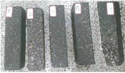
图8 桩基混凝土试块在A组溶液中养护冻融循环150次后的损伤情况
