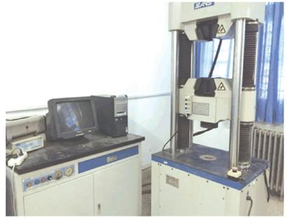
图 6 电液伺服万能试验机
