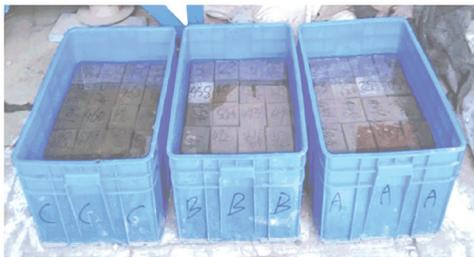
图 5 浸泡在侵蚀溶液中的桩基混凝土试件
