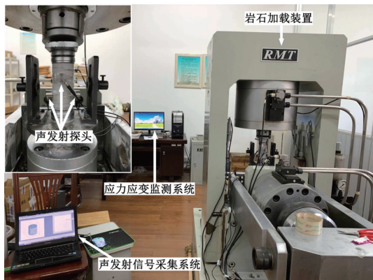
图 3 RMT-150 岩石力学试验系统
