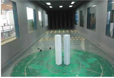
图 4 双子塔的测压模型 (S/B=0.5)
