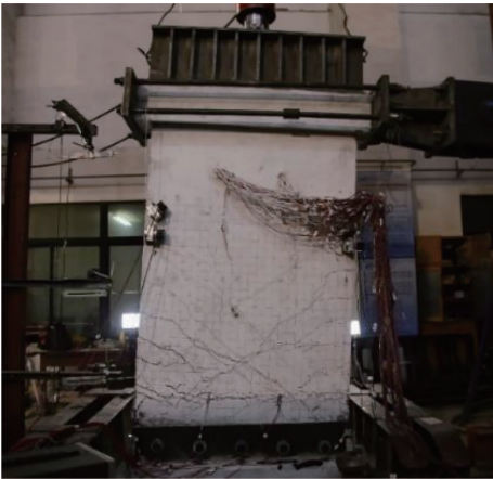
图 14 试件破坏情况
