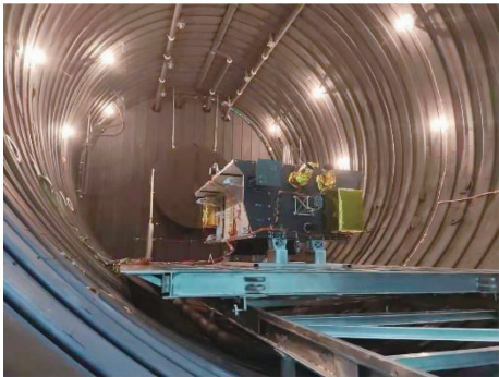
图 13 卫星热平衡试验状态 Fig. 13 Satellite in thermal balance test
