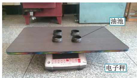
图 2 自由融合燃烧时的多池火试验装置
