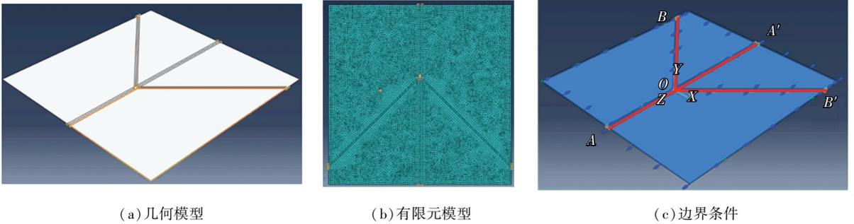
图 10 ABAQUS 中折痕倾角  $\theta < 90^\circ$  的计算模型
