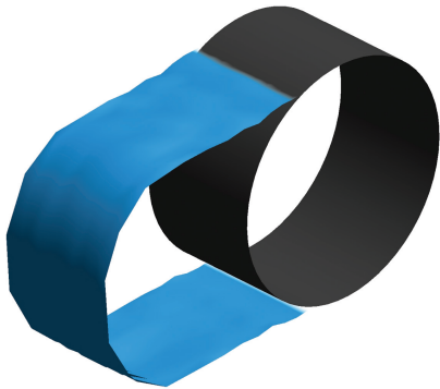
(a) 仿真计算 30 min 后覆冰形貌
