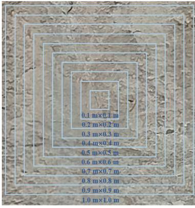
图 10 结构面采样尺寸范围划分图
