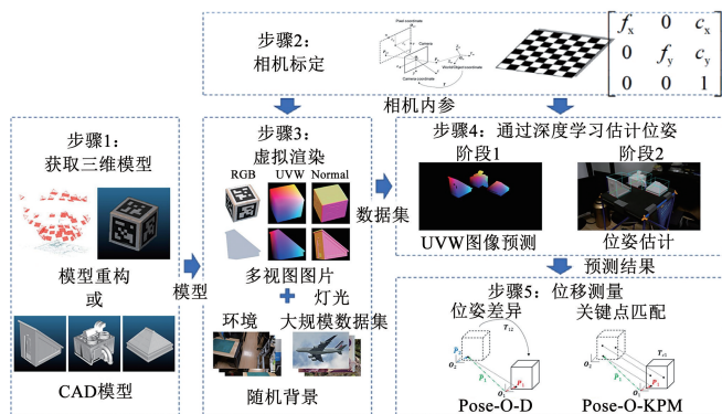
(a) 基于单目视觉与深度学习位姿估计的结构三维位移测量 [71]
