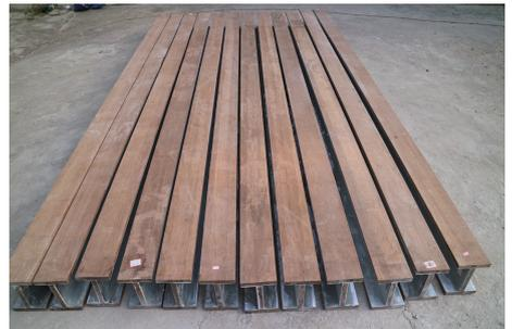
图 1 钢-竹组合工字形梁试件
