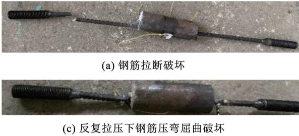
(a) 钢筋拉断破坏
